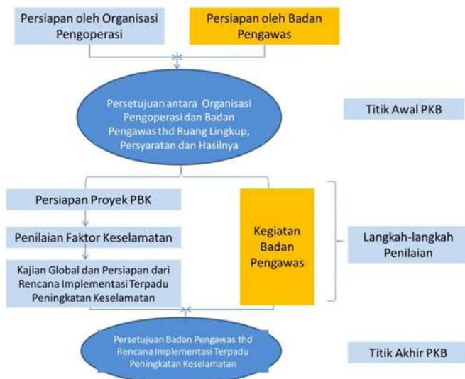
**Gambar 1:** Diagram alir proses PKB reaktor nondaya
